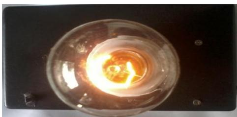
Gambar 3.10. Lampu Bohlam Menyala dengan Sumber Tegangan 180 Volt
